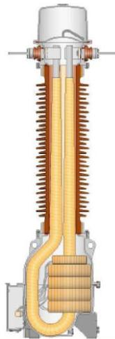
Figure 13 : transformateur de courant
