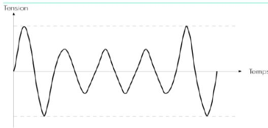
Figure 4a : Creux de tension
