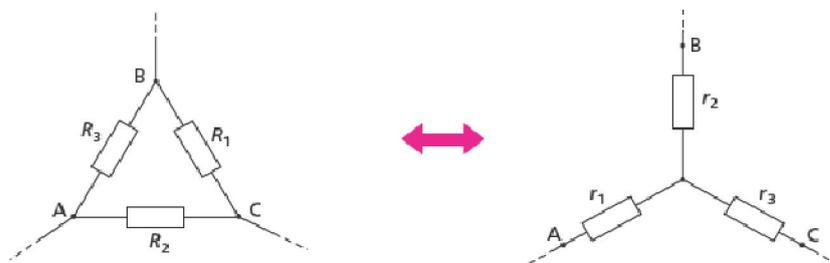
Soient 3 nœuds A, B, C formant un triangle. Chaque brin contient uniquement une résistance (éventuellement équivalente), notées ici  $R_1$ ,  $R_2$  et  $R_3$ , Ce circuit triangulaire est équivalent au circuit en étoile entre les 3 mêmes nœuds, avec un point « central », relié aux 3 nœuds par les résistances  $r_1$ ,  $r_2$  et  $r_3$  (remarquer les notations la résistance  $R_1$  est « opposée » au nœud A relié à  $r_1$ ).
