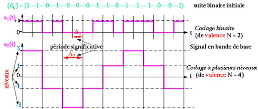
FIGURE 41 – Notion de valence d'un signal.
