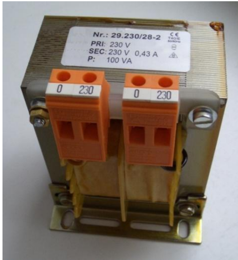
Figure 1.27. Transformateur monophasé d'isolation (230/230, 100VA).
