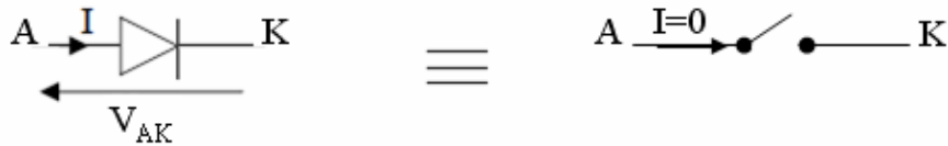
Figure 11 : Schéma équivalent de la diode réelle polarisée en inverse.
