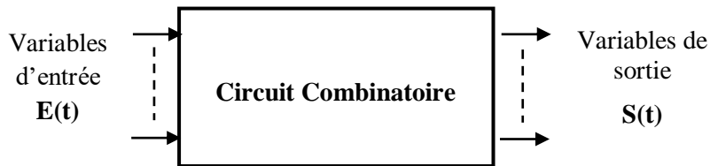
Fig. 2.1 : schéma représentatif d'un circuit combinatoire.
