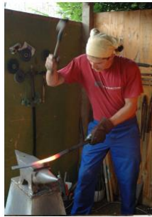
Fig. 6.1 Forgeage libre au marteau manuel.
