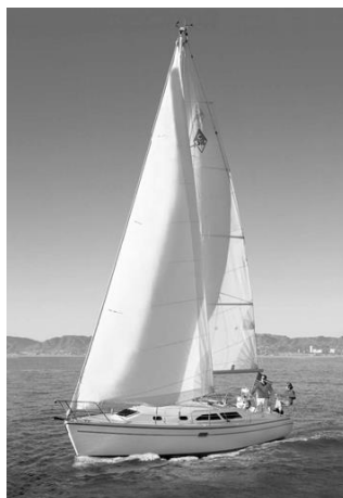
Fig. 9.9- Un bateau de plaisance avec une coque en composite (PRFV), une mâture en alliage d'aluminium et la voilure en fibres polymères synthétiques (crédit : Catalina Yachts, Inc.).
