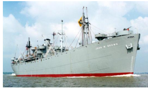
Fig. 9.8- Cargo à coque soudée, Liberty ship SS John W. Brown toujours à flot à Baltimore
