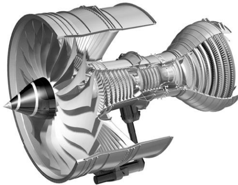
Fig. 9.11- Coupe d'un moteur à réaction typique (Rolls-Royce plc.).
