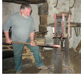
Fig. 6.2 Forgeage libre au marteau-pilon.
